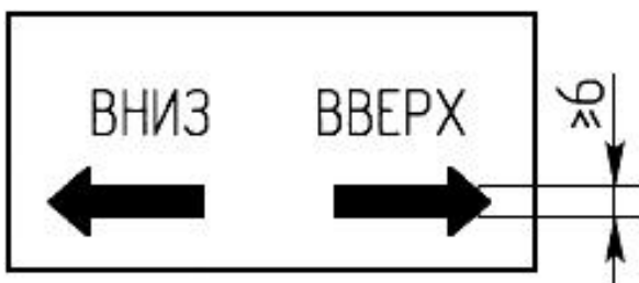
Рисунок 3 - Образец таблички с указанием направления перемещения
