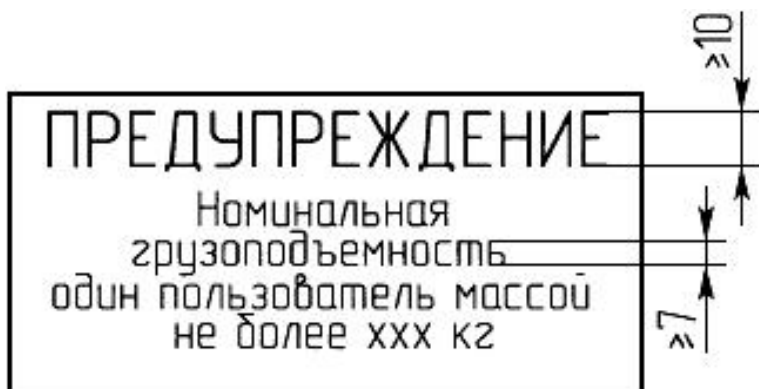
Рисунок 15 - Образец стандартной надписи с информацией о грузоподъемности
