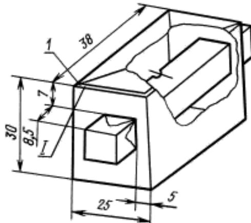
1 — прорезь для залива жидкого водорода
