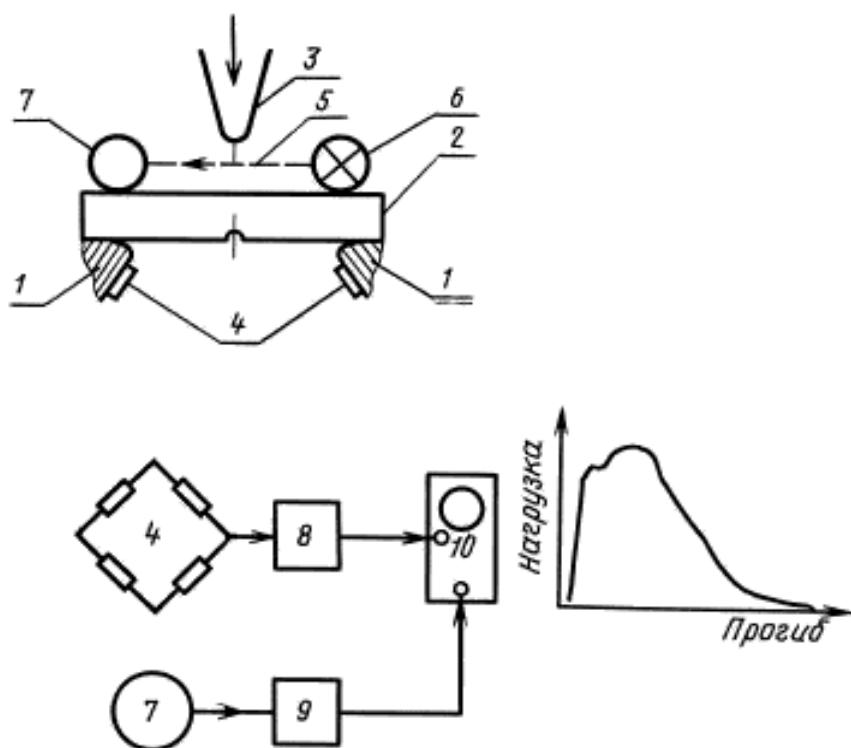
1 — опоры маятникового колпра; 2 — образец; 3 — нож молота; 4 — тензорезисторы; 5 — шторка; 6 — осветитель; 7 — фотодатчик; 8, 9 — усилители; 10 — осциллограф
