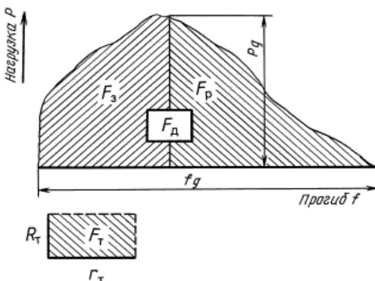
б) планиметрированием определяют общую площадь диаграммы деформации  $F_d$  в  $\text{мм}^2$ ;
