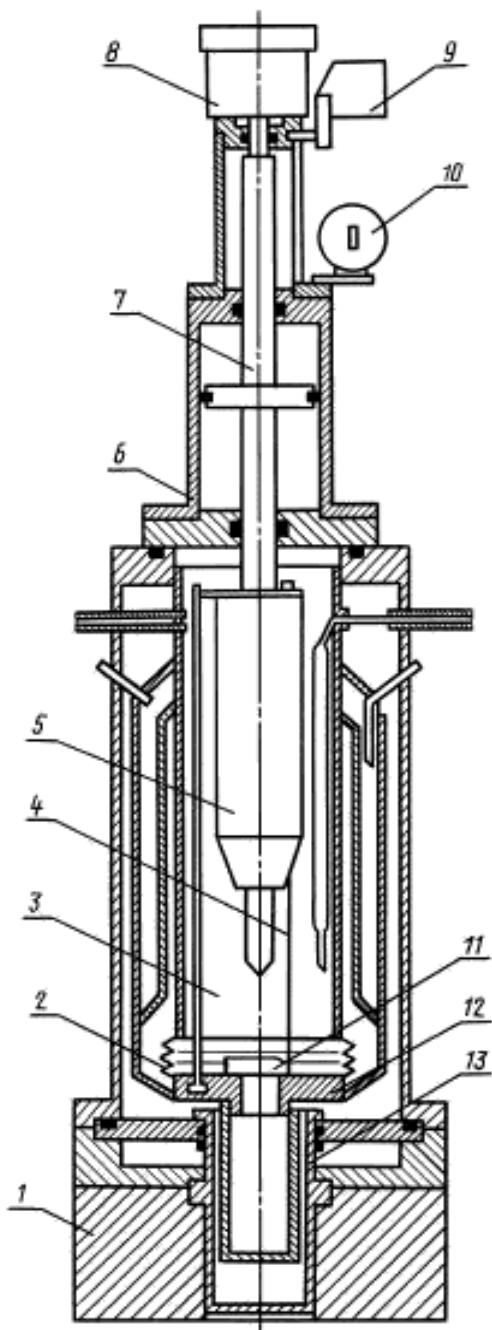
1 — основание копра; 2 — сильфон; 3 — объем для заливки жидкого хладоагента; 4 — тяги; 5 — молот; 6 — пневмоцилиндр; 7 — шток; 8 — шариковый замок; 9 — шторка; 10 — фотодатчик; 11 — образец; 12 — наковальня; 13 — динамометр
