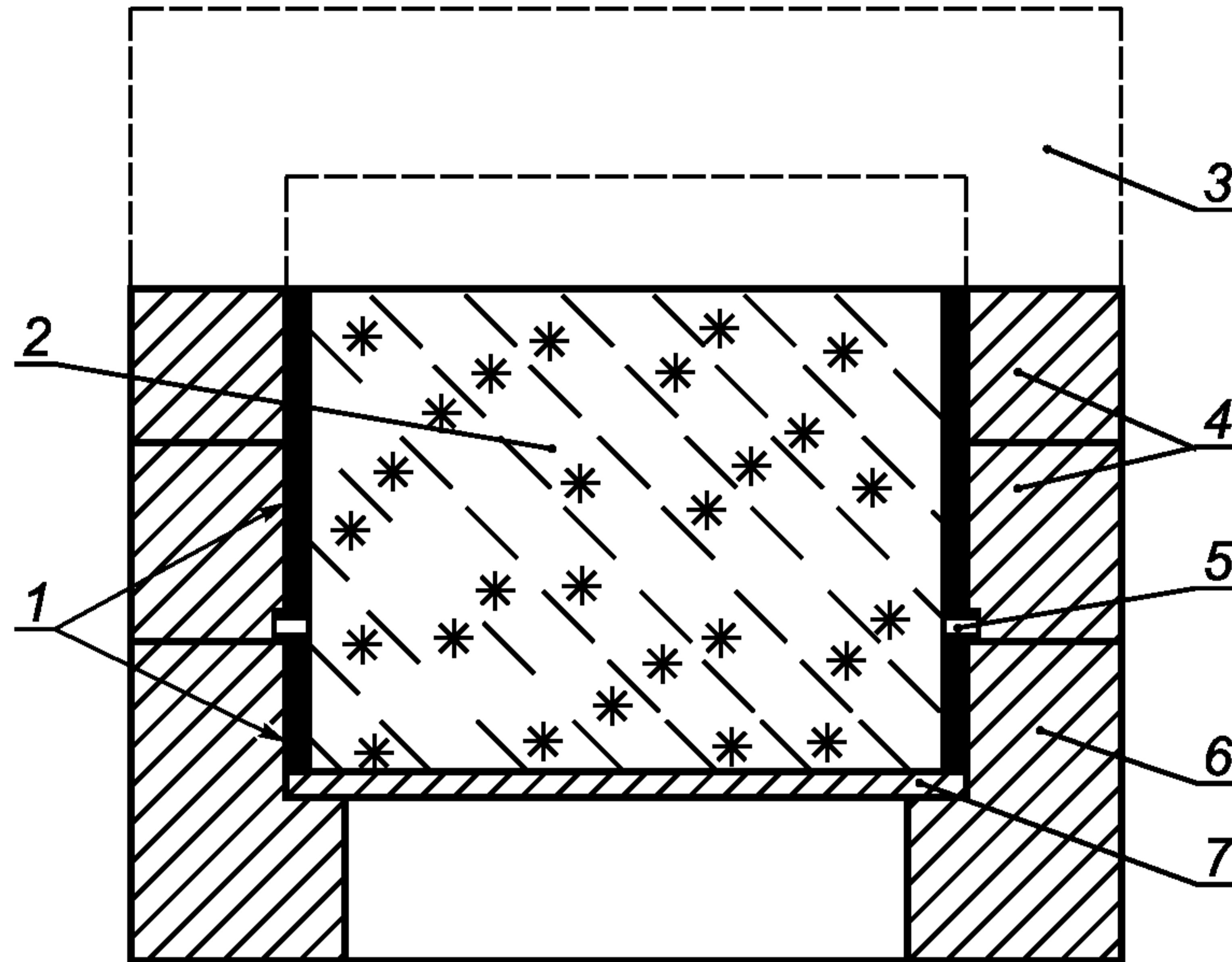
1 — рабочее кольцо; 2 — грунт; 3 — крышка формы; 4 — защитное кольцо формы; 5 — кольцевая прокладка; 6 — опорное кольцо формы; 7 — диск-вкладыш
