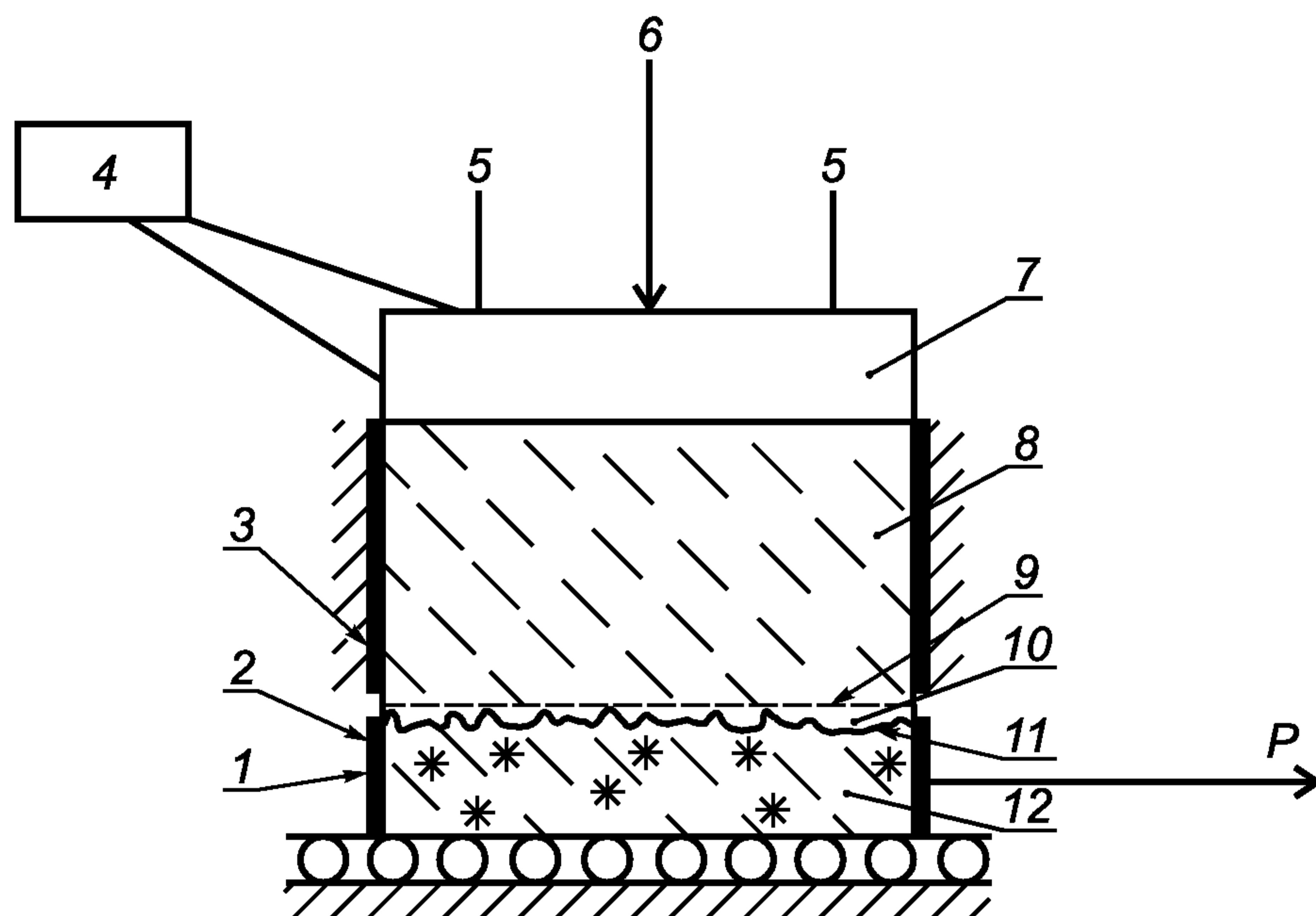
1 — индикатор часового типа для измерений деформаций сдвига; 2 — подвижная обойма; 3 — неподвижная обойма; 4 — устройство для создания и регулирования температуры теплового штампа; 5 — индикаторы часового типа для измерения деформации осадки; 6 — вертикальная нагрузка; 7 — тепловой штамп; 8 — оттаивающий грунт; 9 — плоскость среза; 10 — приконтактный слой (оттаивающий грунт); 11 — граница раздела оттаивающего и мерзлого грунта; 12 — мерзлый грунт;  $P$  — сдвигающая нагрузка
